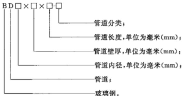
示例: 内径为  $200 \text{ mm}$ , 壁厚  $10 \text{ mm}$ , 长度  $4\ 000 \text{ mm}$  的管道标记为: BD 200×10×4000-C
